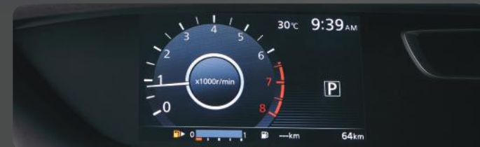
Advance Color TFT Multi Information Display (MID) menyediakan berbagai informasi kendaraan termasuk digital Tachometer.
